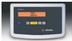
Afficheur L.C.D. de 20 mm, rétroéclairé. Interface de données RS 232C, en série. Connecteur pour fonctionnement avec accumulateur. Matériau de l'indicateur : acier inoxydable. Indice de protection : IP44.
